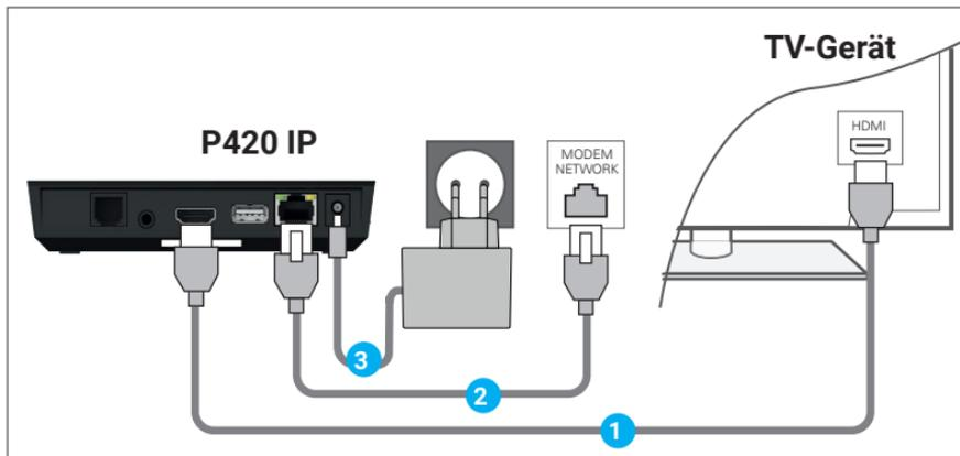
**Abbildung 2:** Kabelverbindungen
